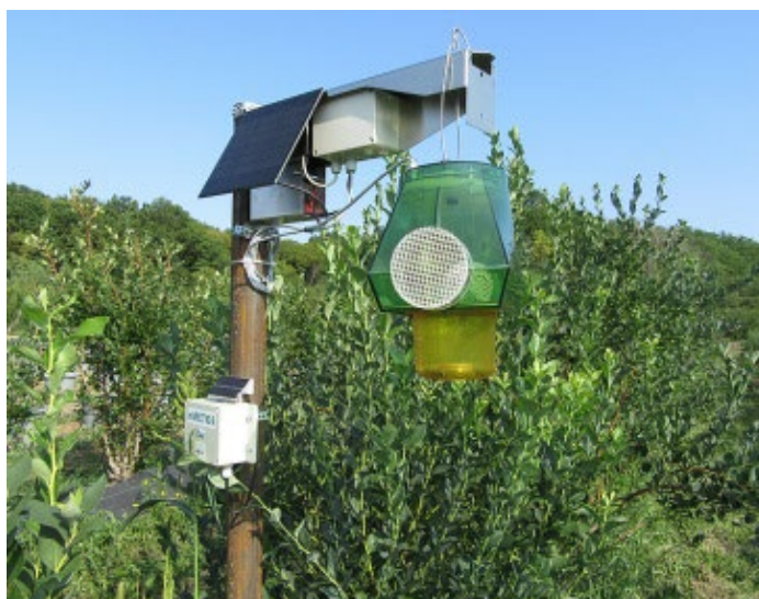
Fig. 29. Dispozitiv electronic ISCOUT Fruit Fly, pentru monitorizarea dăunătorului Drosophila suzukii , instalat în lotul experimental - Ader 6.3.22.
