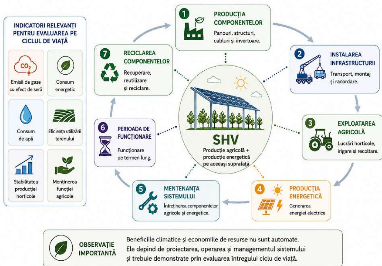
Figura 13.1 – Evaluarea sustenabilității unui sistem hortivoltaic din perspectiva ciclului de viață (LCA) (sursa: elaborare proprie pe baza surselor citate în text)
