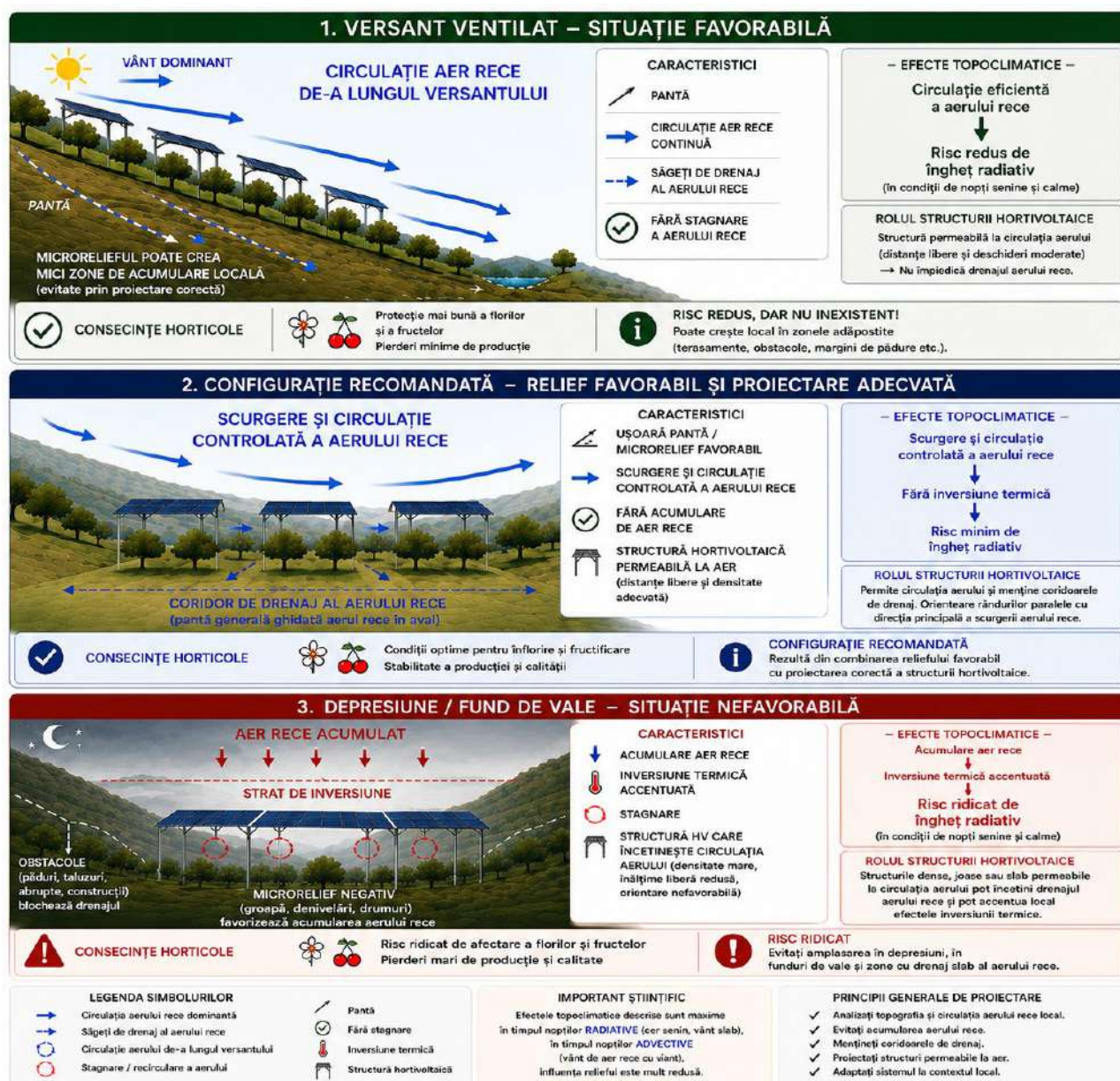
Figura 5.1 – Relația dintre topografie, circulația aerului rece și riscul de îngheț în sistemele hortivoltaice (sursa: elaborare proprie)
