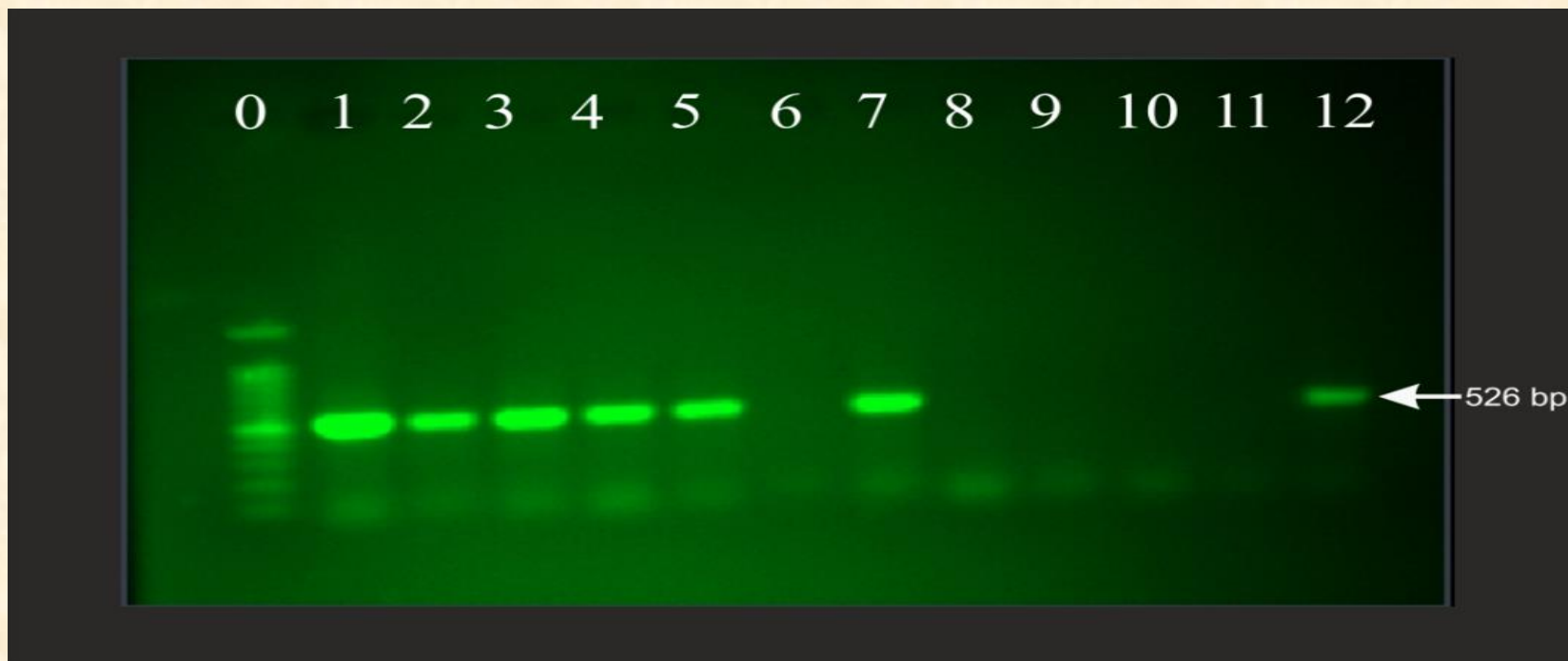
Figura 2. 0. Electroforeza în gel de agaroză a produșilor PCR obținută cu primer-ul AM-19: 100-1500 bp DNA ladder, 1. Bistrițean, 2. Salva, 3. Aura, 4. Florina, 5. Ariwa, 6. Goldrush, 7. Prima, 8. Hibrid Zagrai, 9. Idared, 10. Golden Delicious, 11. Apă, 12. Florina
